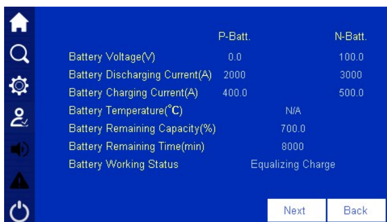
Figure4-20 Stato di inversione di rete, carica della batteria
